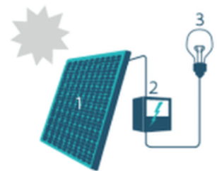
1. Zonnepaneel | 2. Omvormer | 3. Elektrische toestellen
